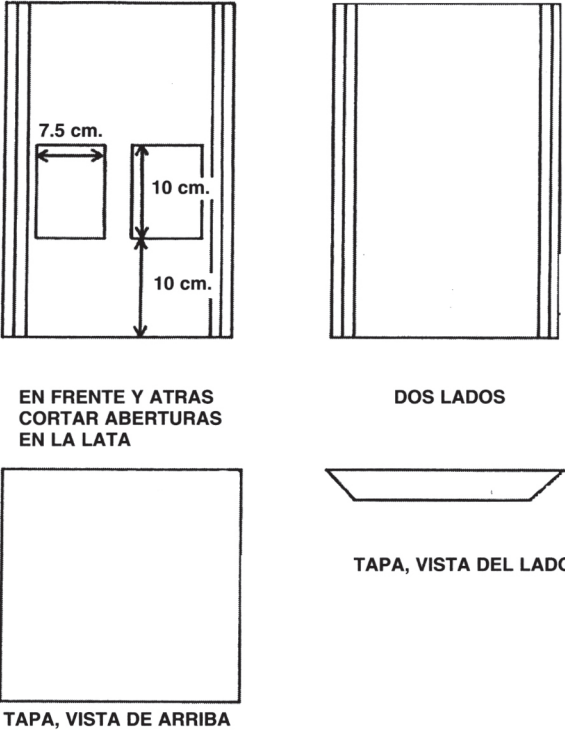
Figura 29. Comedor automático hecho de una lata de 5 galones (20 litros)
